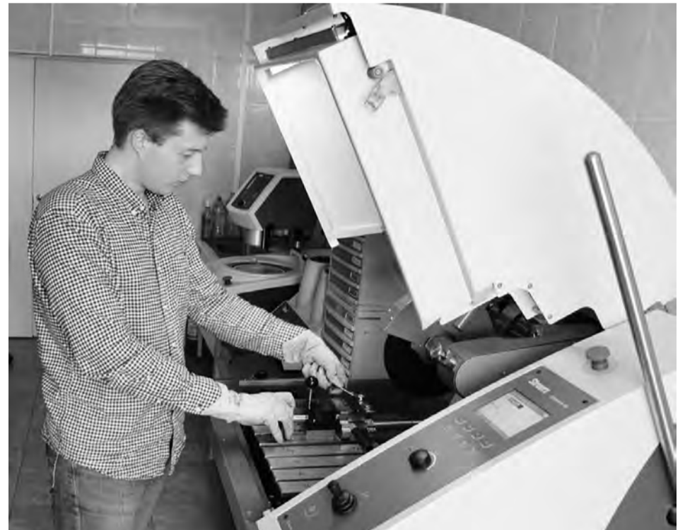
Инженер-лаборант Д.В.Михеев готовит образцы для металлографических исследований на абразивно-отрезной машине
