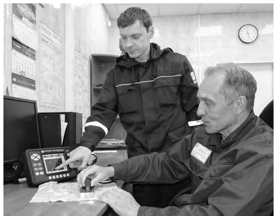
Дефектоскописты А.Г.Молотков и А.В.Морозов (справа) выполняют настройку ультразвукового дефектоскопа
